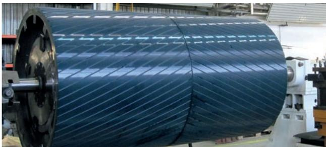
Trommelbeschichtung mit Polyurethan
